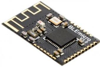
Eine modernere Lösung bieten BLE Bluetooth 4 Module (HM-11), jedoch besitzen die keinen SPP seriellen COM-Port, weshalb sie nur mit Android 4.x oder iOS Geräten funktionieren. Die meisten Module sind mit einer Baudrate von 9600 vorkonfiguriert. Auch benötigen sie 3,3V, die an anderer Stelle auf der FC abgegriffen werden können.
